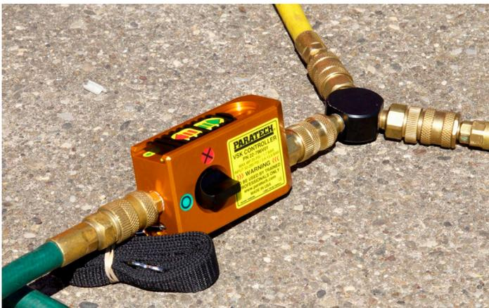
Der VSK Controller ist auf 1,7 bar gesichert und eignet sich besonders für die pneumatisch unterstützte Sicherung beim Heben von Lasten nach schweren Verkehrsunfällen.
