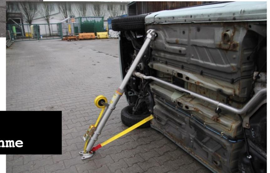
**Indirekte Lastaufnahme über Spanngurt**
